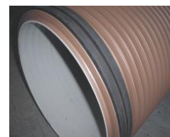
Fig. 5 Ønsker man at anvende ultra rør SKAL indlæg monteres i sporene på ultrarøret således at spændebåndet på koblingen får et glat og fast underlag at tilspænde på.
