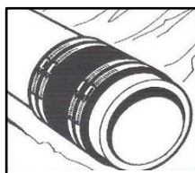
Fig. 2 Spændebåndene løsnes og overgangen monteres på rørenden.
