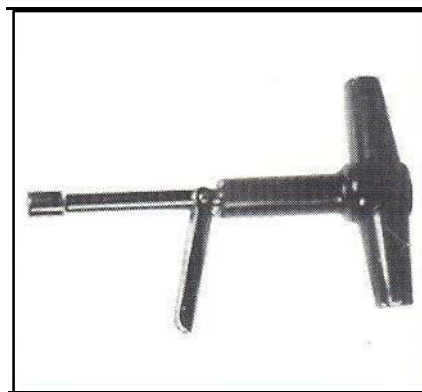
Fig. 6 Bespænding kan foretages med Fenco momentnøgle 12 Nm.
