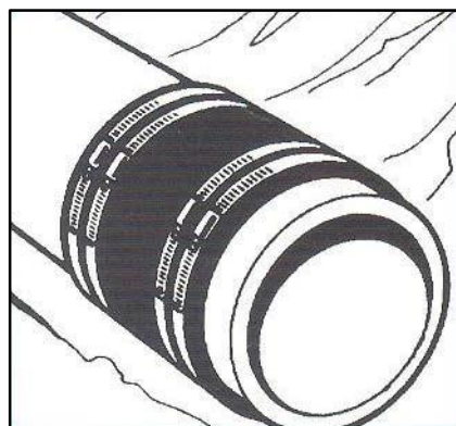
Fig. 2 Spændebåndene løsnes og overgangen monteres på rørenden.
